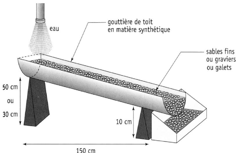
Le modèle est constitué d'une gouttière portée par 2 supports. Un support de 10 cm de hauteur et un support de hauteur variable.
