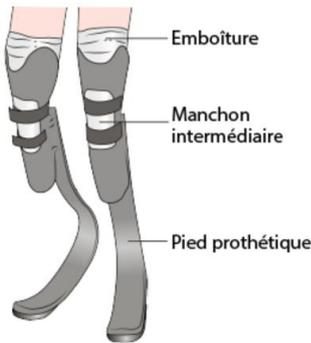
Lors de la course, la courbe « J » de la prothèse se comprime à l'impact, stockant ainsi l'énergie et absorbant de hauts niveaux de contrainte qui, chez le coureur normal, seraient absorbées par la cheville, le genou, la hanche et le bas du dos.
